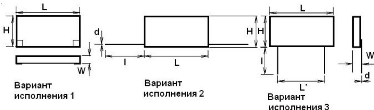
Вариант исполнения 1-без защитного покрытия и выводов. Варианты 2 и 3 имеют защитное эмалевое покрытие толщиной до 0,5 мм. Допускается изготовление резисторов вариантов исполнения 2 и 3 без защитного покрытия по согласованию с заказчиком.
